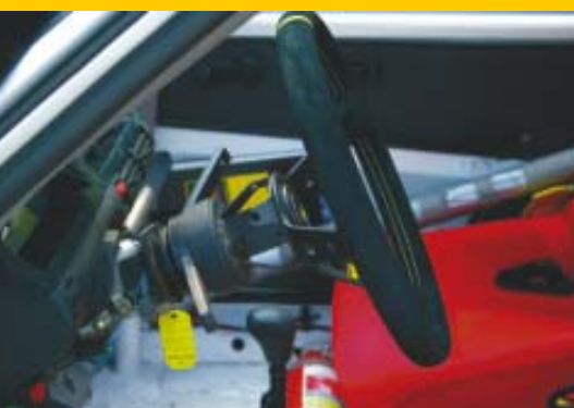
„Odsadzona” kierownica OMP zamontowana jest na nabie dystansowej.
