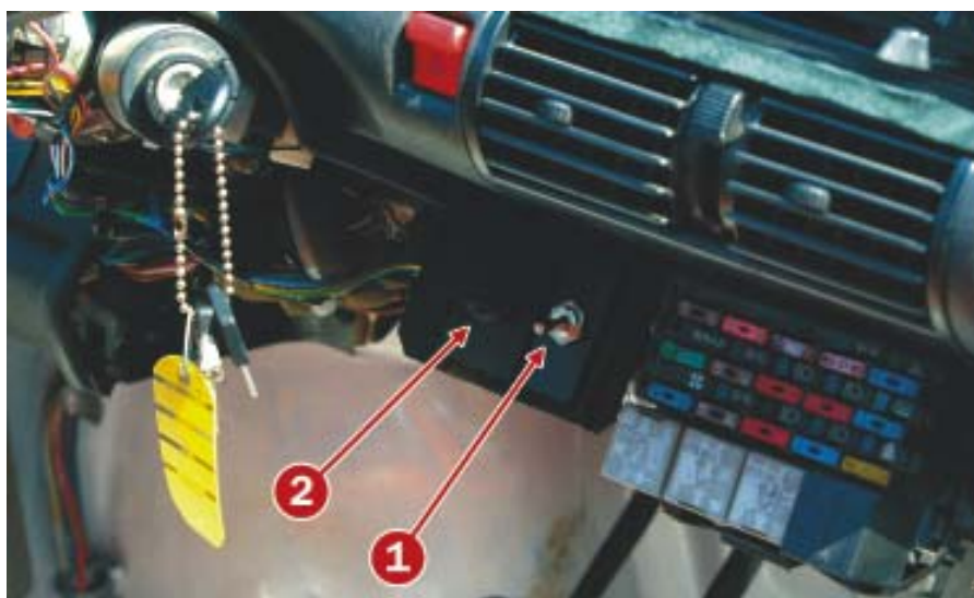
Aby uruchomić silnik przekręcamy kluczyk, włączamy pompę paliwa (1) i naciskamy przycisk startu (2). Obok zestaw bezpieczników.
