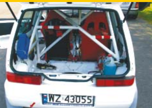
Klatka bezpieczeństwa A-grupowego Fiata jest znacznie bardziej rozbudowana niż w przypadku większości N-grupowych Cinquecento.
