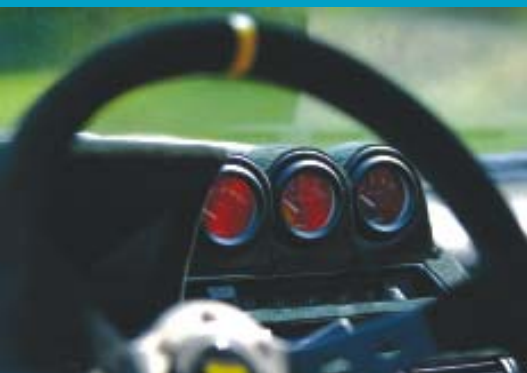
Od lewej wskaźnik ładowania akumulatora, temperatury oleju i jego ciśnienia.
