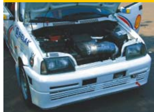
Specjalny wlot powietrza w zderzaku doprowadza zimne powietrze do silnika. Ten osiąga moc 66 KM.
