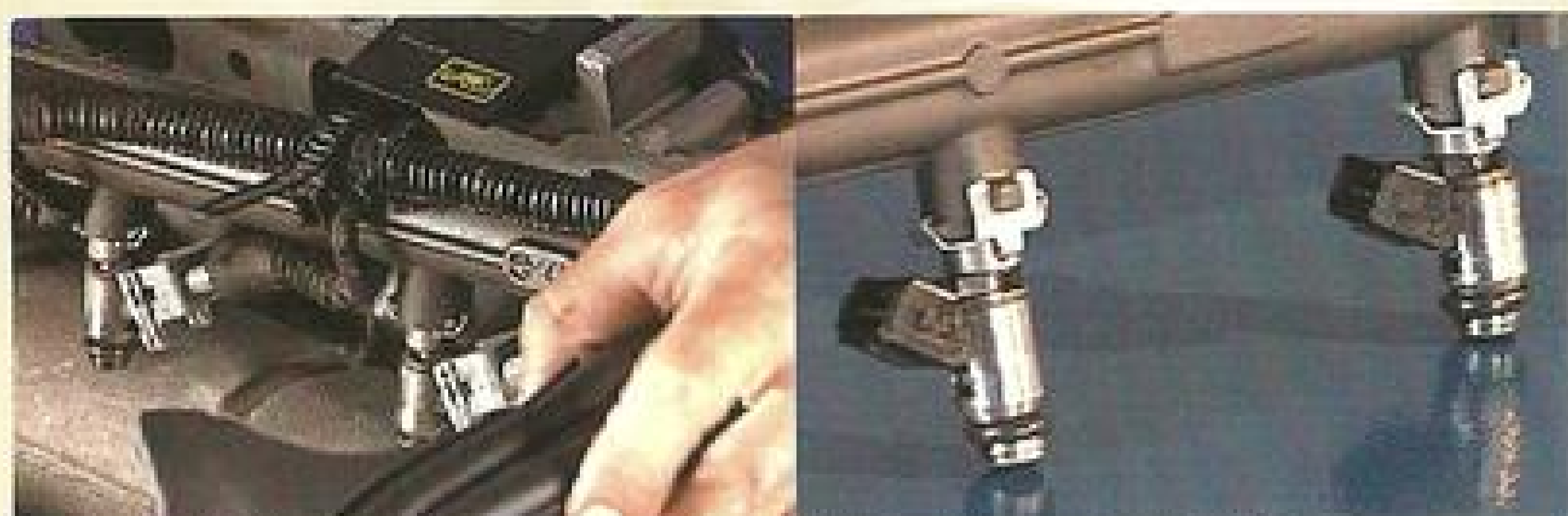
Localização do tudo distribuidor, sob o tubo coletor de admissão; destaque para os eletroinjetores
