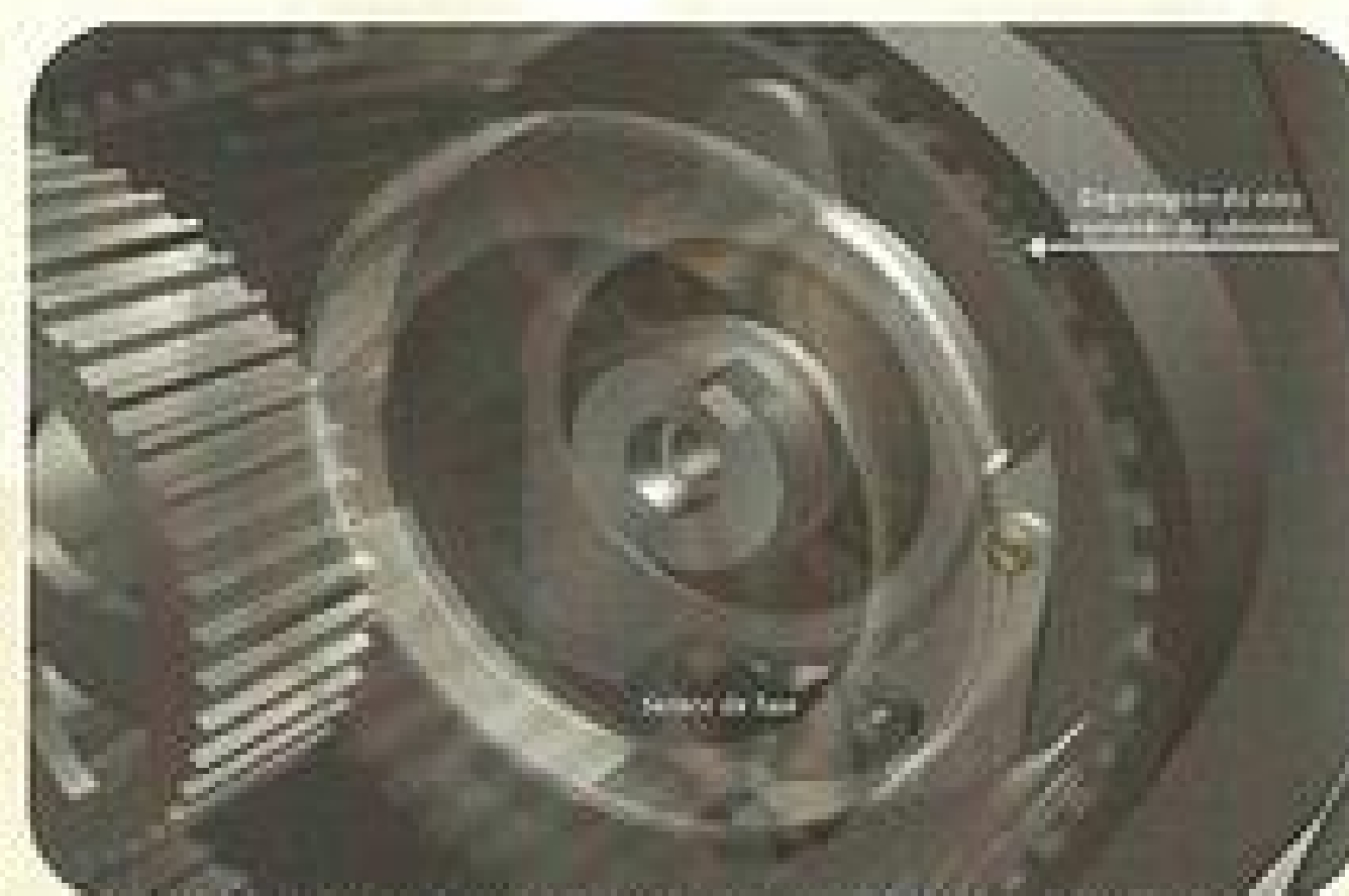
Localização do sensor de fase posterior à engrenagem do eixo do comando de admissão
