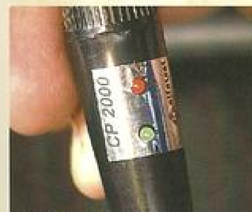
Os dois LEDs devem piscar ao acionar o motor de partida
