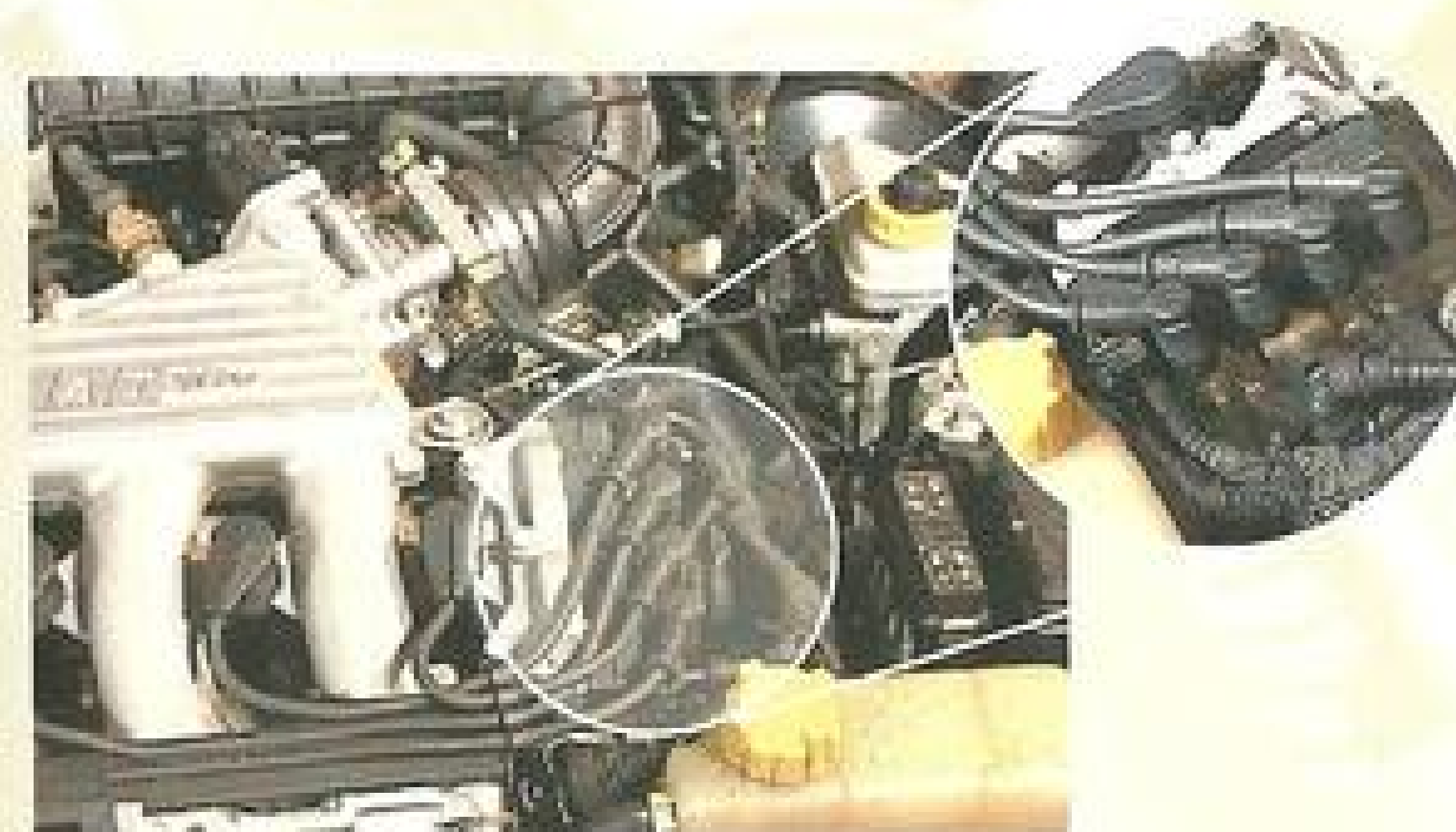
Localização e detalhe da bobina de ignição
