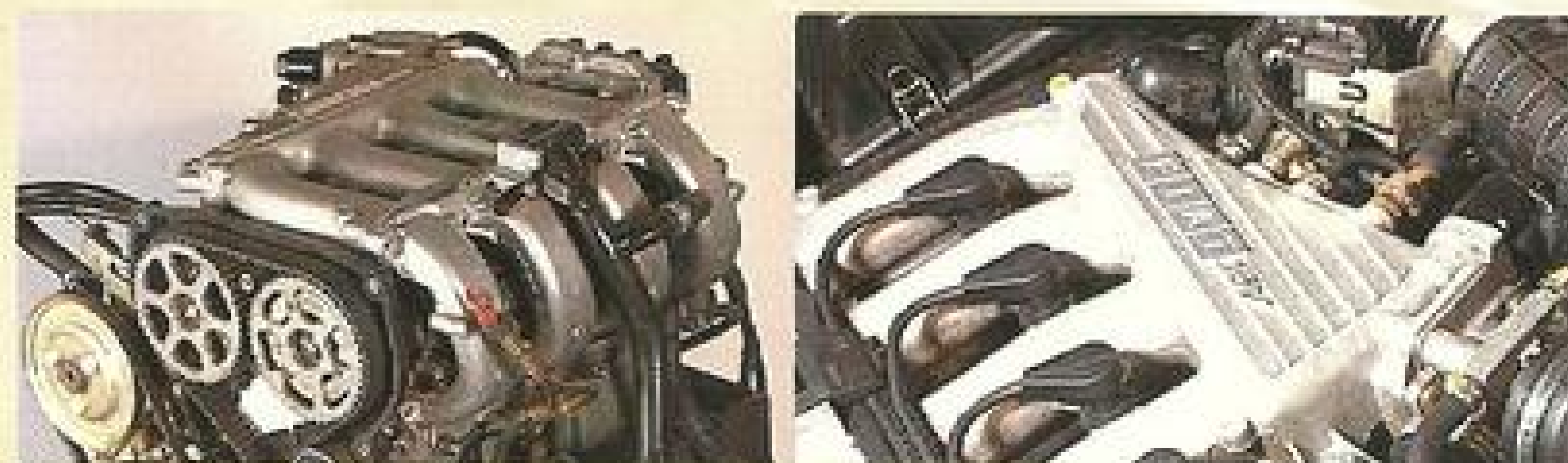
Posicionamento do coletor de admissão, com destaque para alojamento do corpo de borboleta e seus componentes
