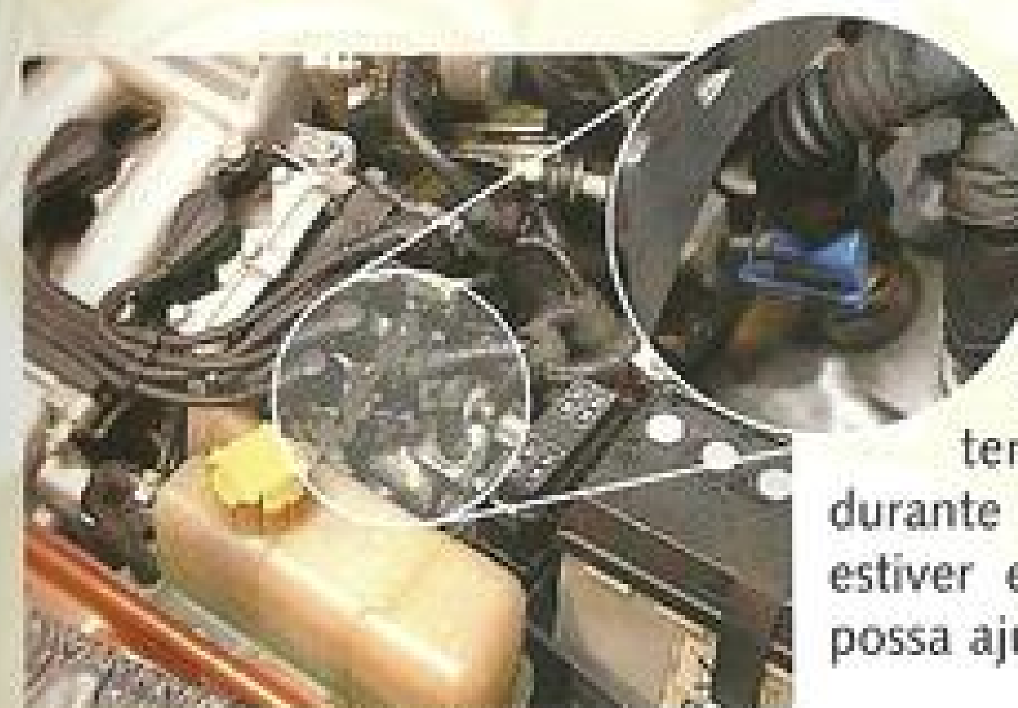
Localização e detalhe do sensor de temperatura.
