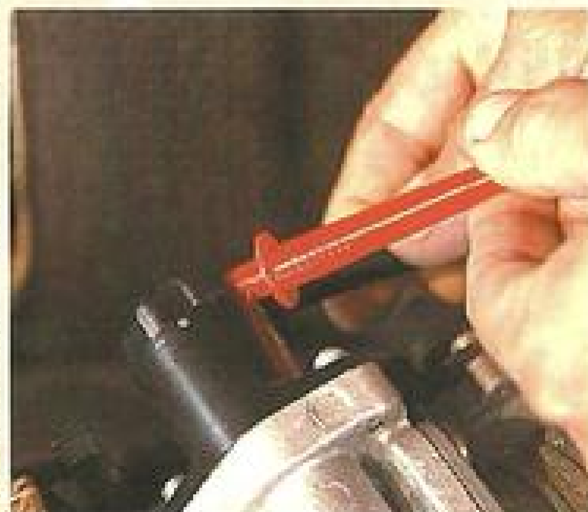
Pontas de prova junto ao atuador de marcha lenta
