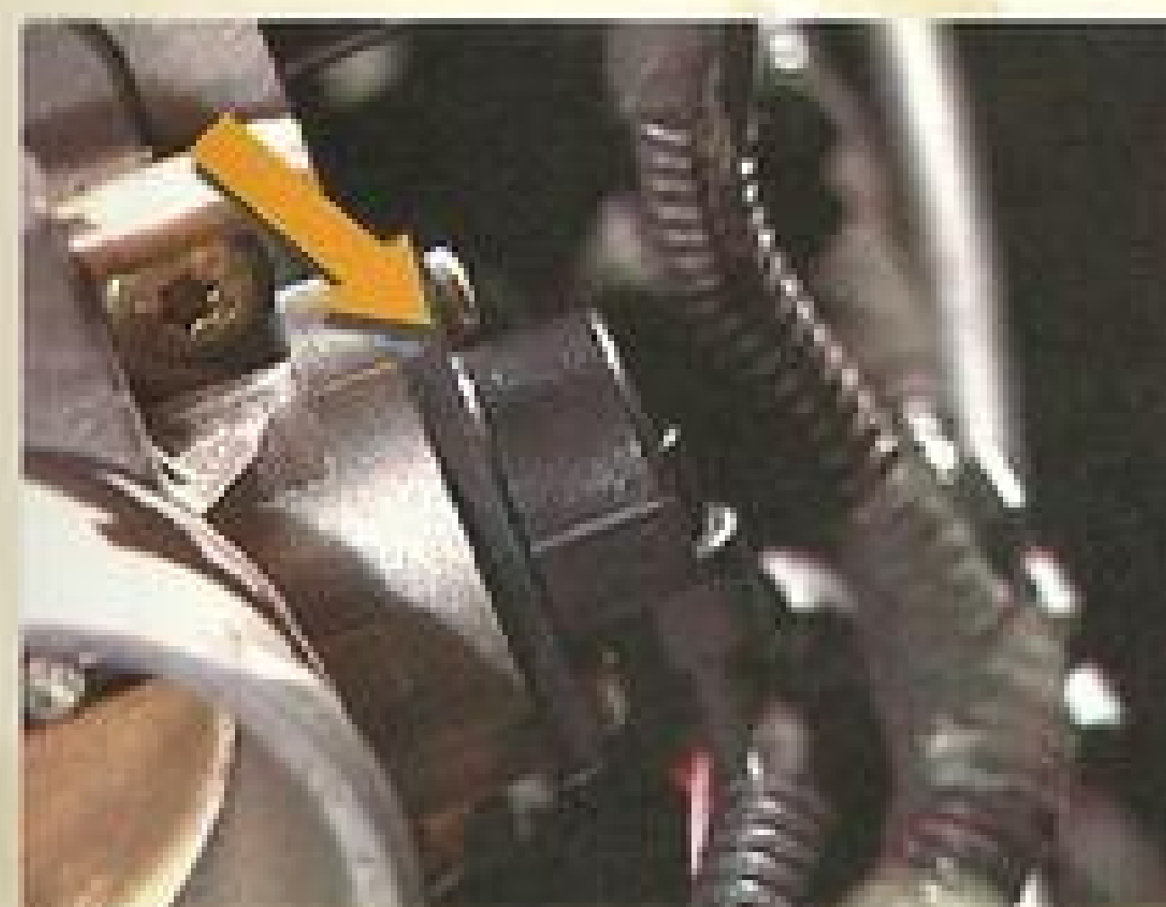
Localização do sensor de posição da borboleta
