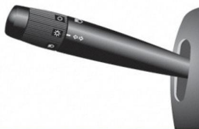
Interruptor de múltipla função comutado para o acionamento das luzes de posição
