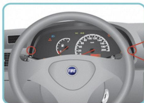
F.3-Parafusos para remoção do painel
