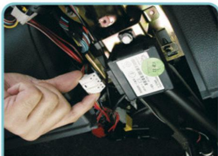
Desconecte a central FIAT CODE para testar um novo módulo de comando
