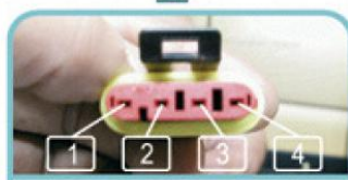
Conector do medidor de combustível antigo
