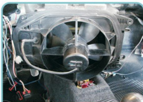
O motor do ventilador interno não possui conector aparente
