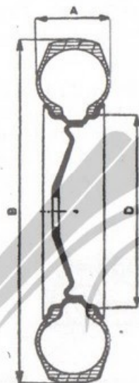
Fig. 2 - Sezione di una ruota gommata per autovettura.
