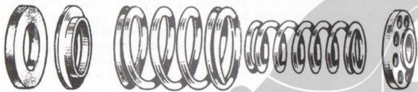
Fig. 65 - Le molle speciali per valvole ABARTH sono dotate di appositi scodellini alleggeriti e di rosette di materiale antivibrante.
