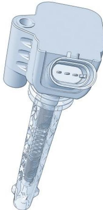
La cabeza de la bobina se conecta a la bujía mediante un capuchón de goma silicónica que contiene un muelle que transfiere la alta tensión del devanado secundario al terminal de la bujía.
