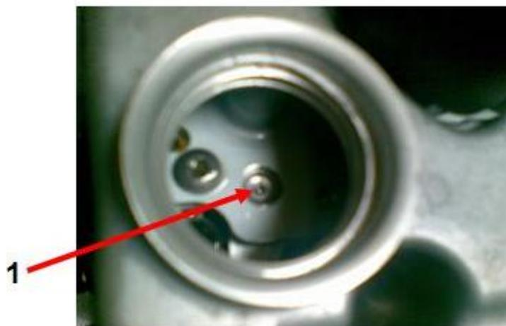
1. Válvula unidireccional para entrada de aceite de precarga al nuevo módulo Cant. 240 ml
