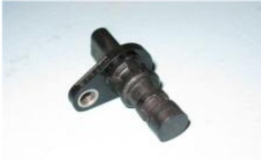
Una capa semiconductor recorrida por corriente, sumergida en un campo magnético normal (líneas de fuerza perpendiculares al sentido de la corriente), produce una diferencia de potencial en sus terminales conocida como tensión de "Hall".
