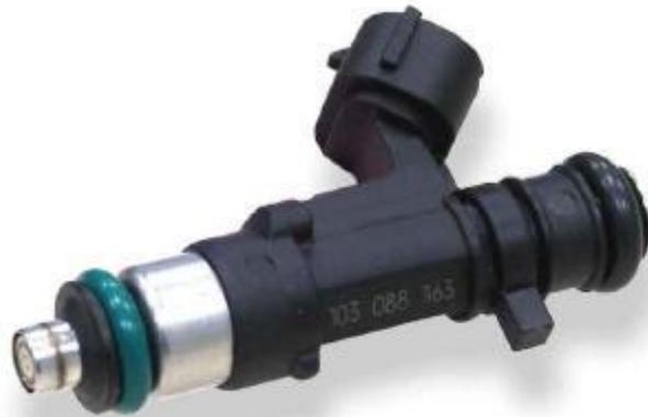
Los inyectores de las versiones aspiradas tienen las mismas estrategias que las versiones con turbocompresor. Son de fabricación Bosch tipo Ev14 con las características siguientes:
