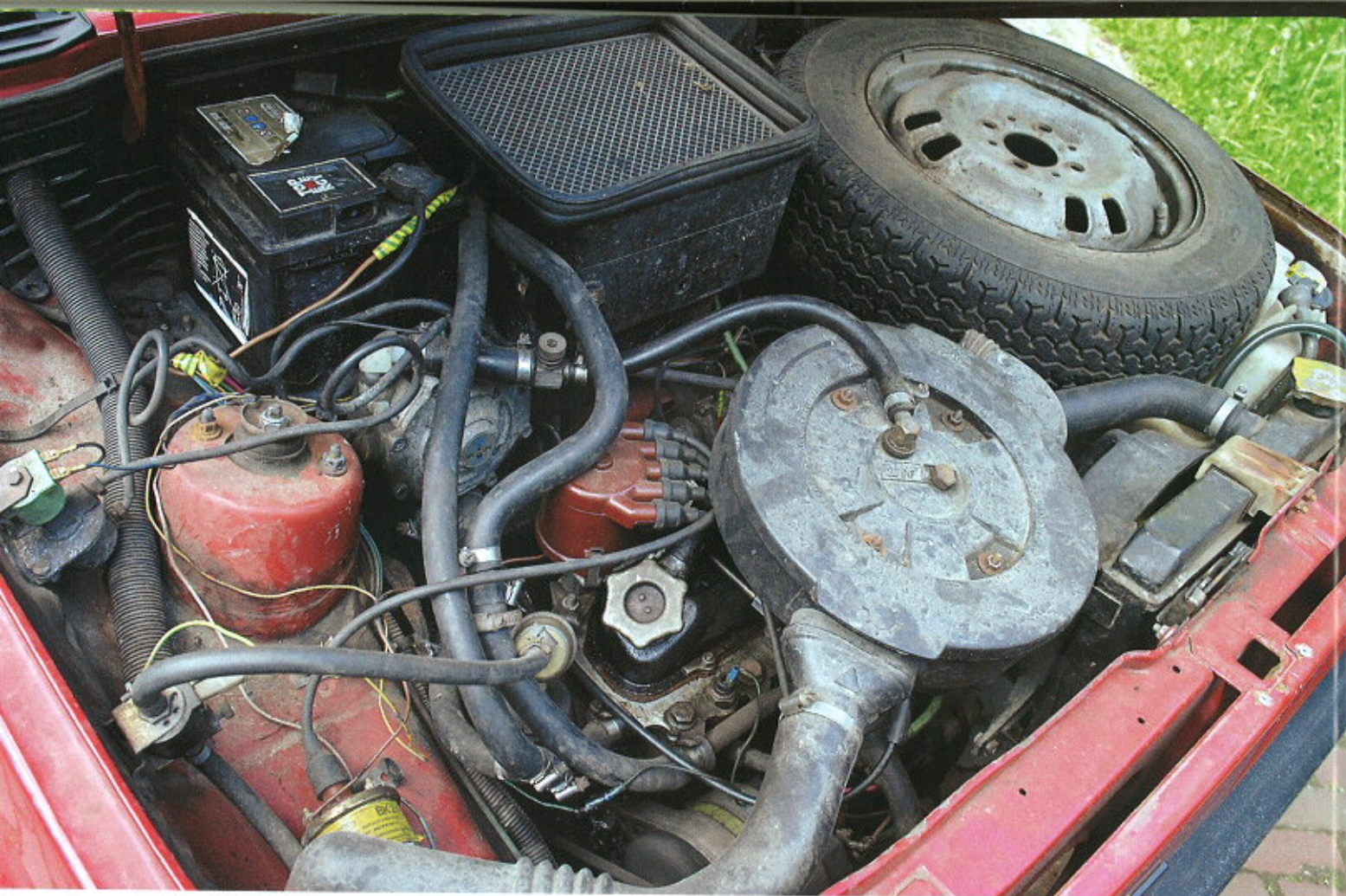
Stary znajomy, czyli silnik OHV 903 cm 3 . Do niedawna (ze zmniejszoną do 899 cm 3 pojemnością) napędzał jeszcze Seicento. Koło zapasowe pod maską oznacza więcej miejsca w bagażniku.
