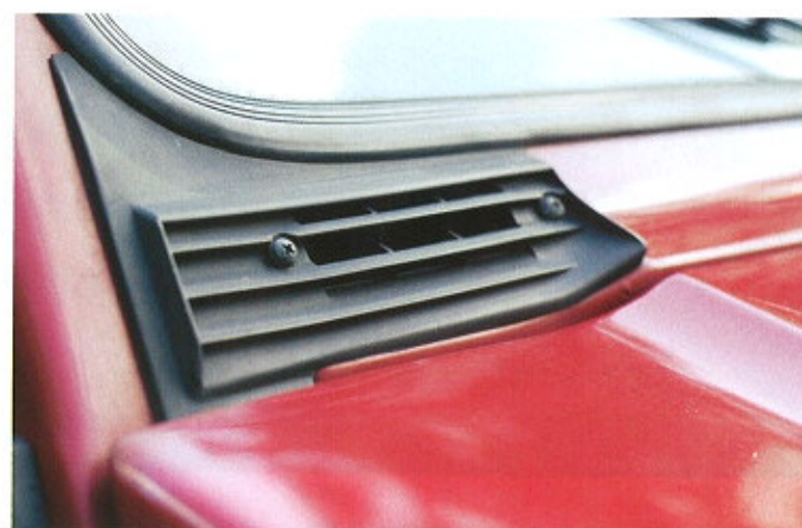
Ważny element systemu przewietrzania Pandy: od wewnątrz mamy podobną kratkę z dźwigiem regulacji żaluzji.
