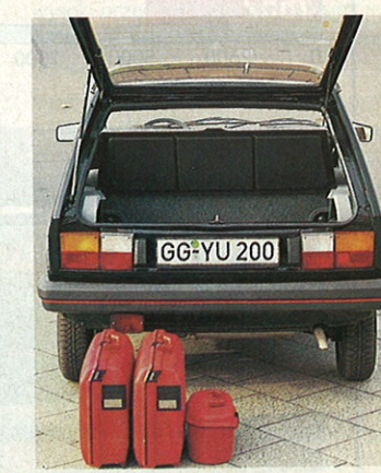
Yugo ma szczelinowy przedział bagażowy, któ- rego duża część pozostała nie wykorzystana
