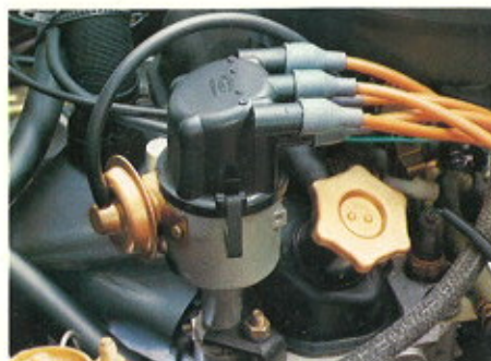
Leistungsgerechte Anpassung des Zündzeitpunkts durch neue Unterdruck-Steuerung (Panda 45)
