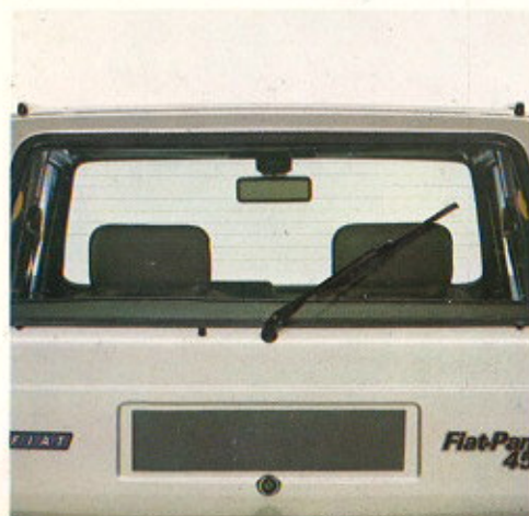
Heizbare Heckscheibe mit elektrischer Wischer/Wascher-Anlage
