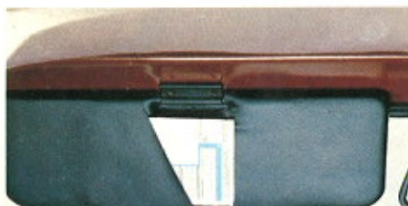
Luftzufuhr aus der staubfreien Zone oberhalb der Motorhaube
