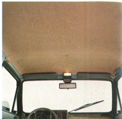
Optisch sauber und akustisch angenehm: der neue Wagenhimmel aus einem isolierenden Stück
