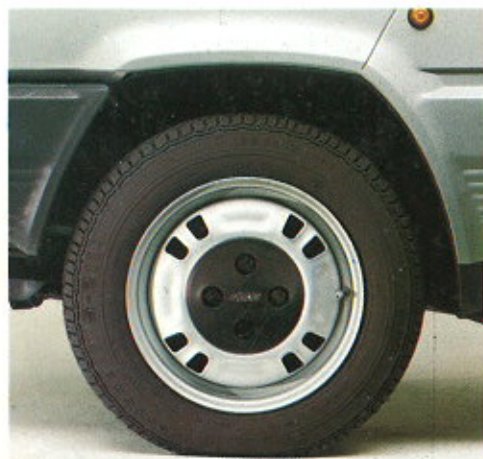
Neue Felgen- und Radkappen-Formen verringern den Luftwiderstand (Super)
