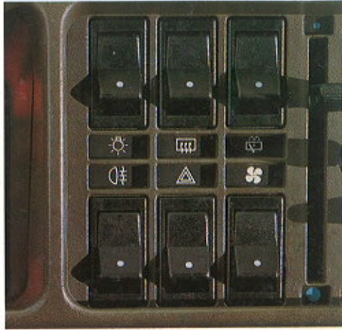
Beleuchtete Drucktasten mit klaren Funktions-Bezeichnungen (Super)
