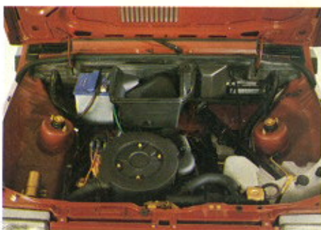
Platzsparend und klapperfrei sind Scheiben-Waschwasser-Behälter und Werkzeug kombiniert
