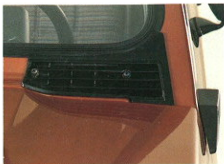
Luftzufuhr aus der staubfreien Zone oberhalb der Motorhaube
