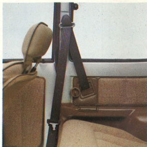
Automatik-Gurte mit verdeckter Rollenführung
