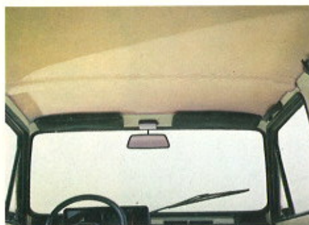
Der neue Wagenhimmel aus einem isolierenden Stück
