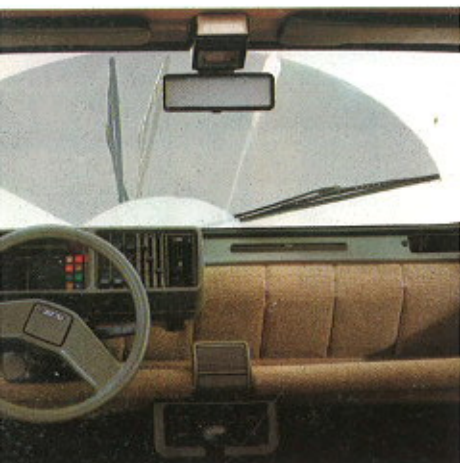
Elektrische Wischer/Wascher-Anlage mit Interall-Schaltung
