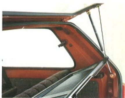
Mit der Heckklappe hochschwenkende Kofferraum-Abdeckung. Panda 45
