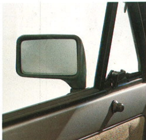
Beim Supermodell zwei Außenspiegel, an der Fahrerseite von innen verstellbar.
