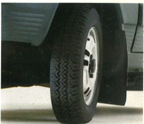
Geländeprofil-Reifen 145 SR 13 und Schmutzfänger an allen vier Radkästen.
