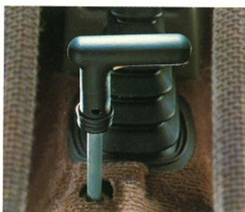
Schalthebel für Allradantrieb.
