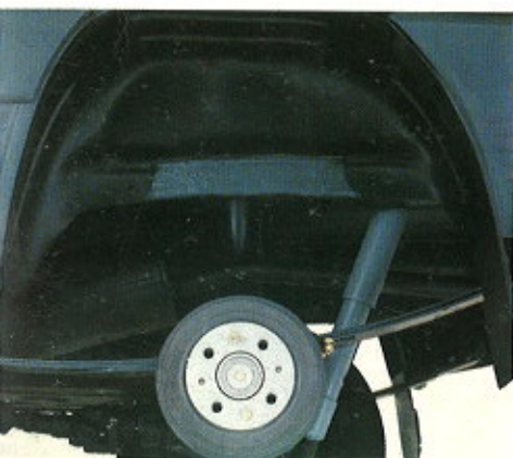
Steinschlagschutz aus Kunststoff in allen vier Radkästen.
