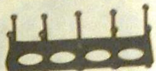
A. 60059 Botador desmontaje guías de válvulas.
