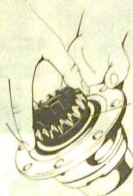
Colocación del anillo de regulación del planetario
